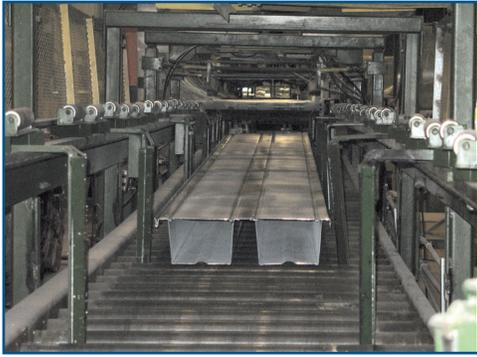
Las cubiertas de piso celular permiten tramos más largos, sistemas de sujeción ocultos y están diseñadas para brindar una apariencia lineal estéticamente placentera. La cubierta de piso celular de diseño acústico reduce los niveles de ruido en el interior de los edificios. Son perfectas para gimnasios, edificios de oficinas, bibliotecas y más.
